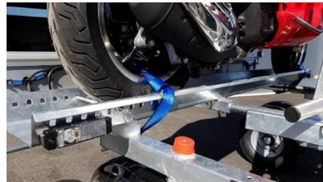
Les cales plastiques doivent être en contact lorsque les sangles sont serrées.
