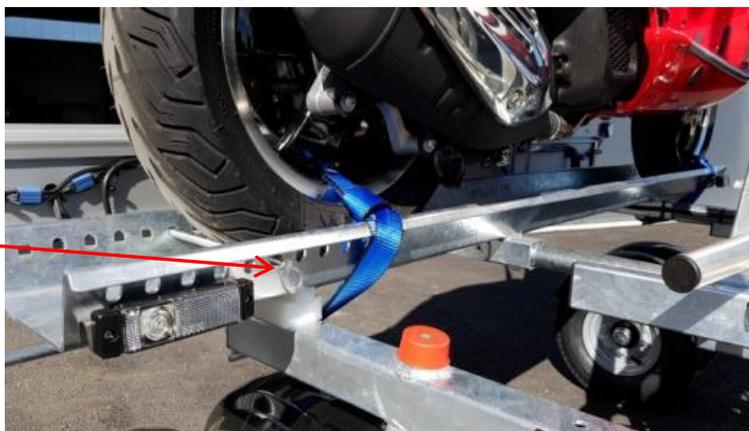
**Astuce :** Pour bien positionner l'axe/goupille de blocage de roues arrière, il est préférable de se mettre à l'arrière du scooter / moto et de pousser en prenant appui sur la roue.
