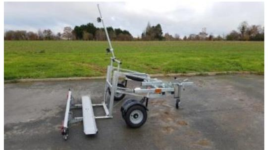
➤ Positionner le scooter / moto en butée sur l'axe de blocage de la roue avant.
