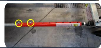
> Serrer les écrous contre écrous pour figer les réglages de votre biellette.
