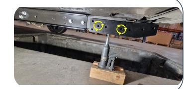
> Tracer les perçages sur la plaque comme ci-contre et percer la plaque Ø13mm
