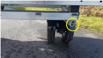
➤ Il est possible de charger et décharger le quad, remorque dételée. Pour cela, vous devez mettre les béquilles arrière au contact du sol pour éviter le basculement.
