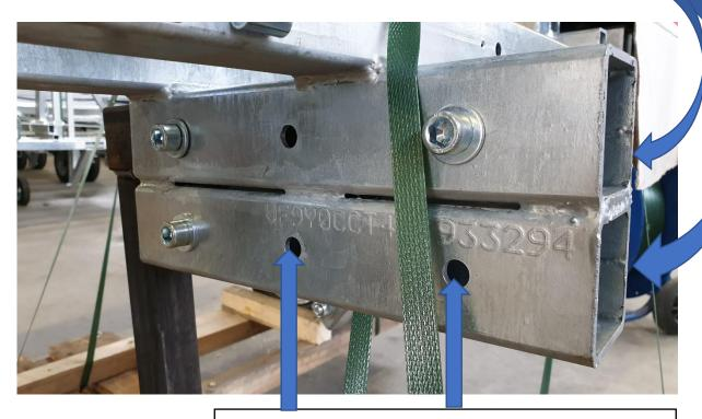
Le timon doit OBLIGATOIREMENT être boulonné en deux points dans les deux trous ci-dessus en utilisant les deux vis disponibles.
